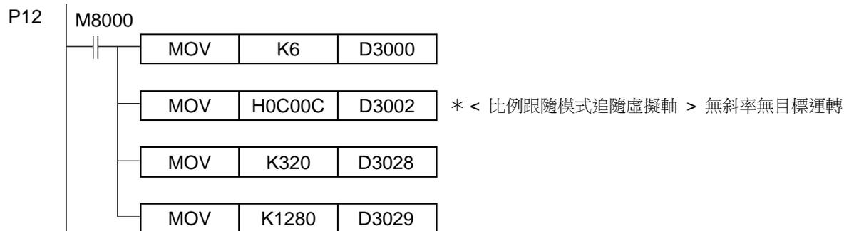
\* 模式 G06 比例跟隨, Y3 方向軸固定 Y7, 電子齒輪比  $401/3208=1/8$
