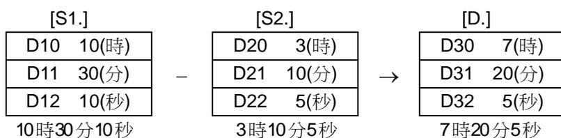
◆ 將儲存在[S1.]開始連續 3 點的時間資料，減去[S2.]開始連續 3 點的時間資料，並將結果存放在[D.]開始連續 3 點的組件。
