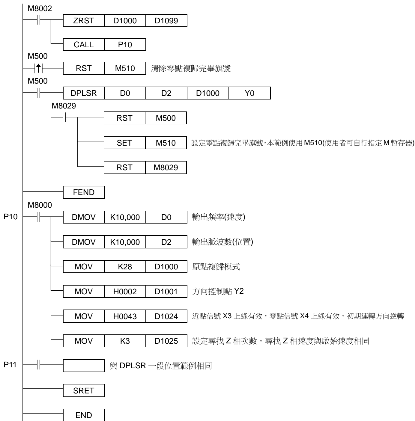
< 模式 0 > D1024=H0043 相同方向尋找零點信號
